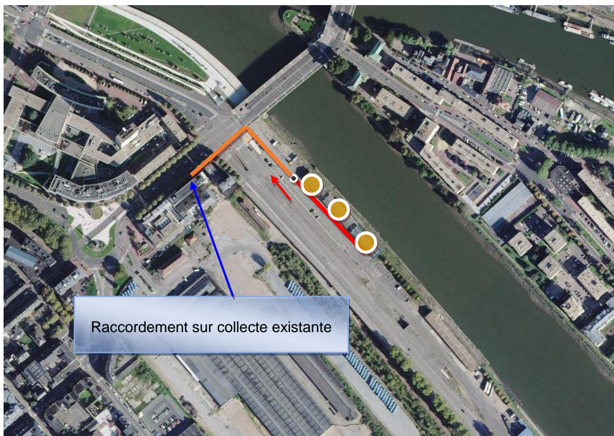
Figure 11 : Représentation graphique de la solution d'assainissement collectif étudiée pour le secteur de la rue Quai Jacques Aquetil (1 unité)
