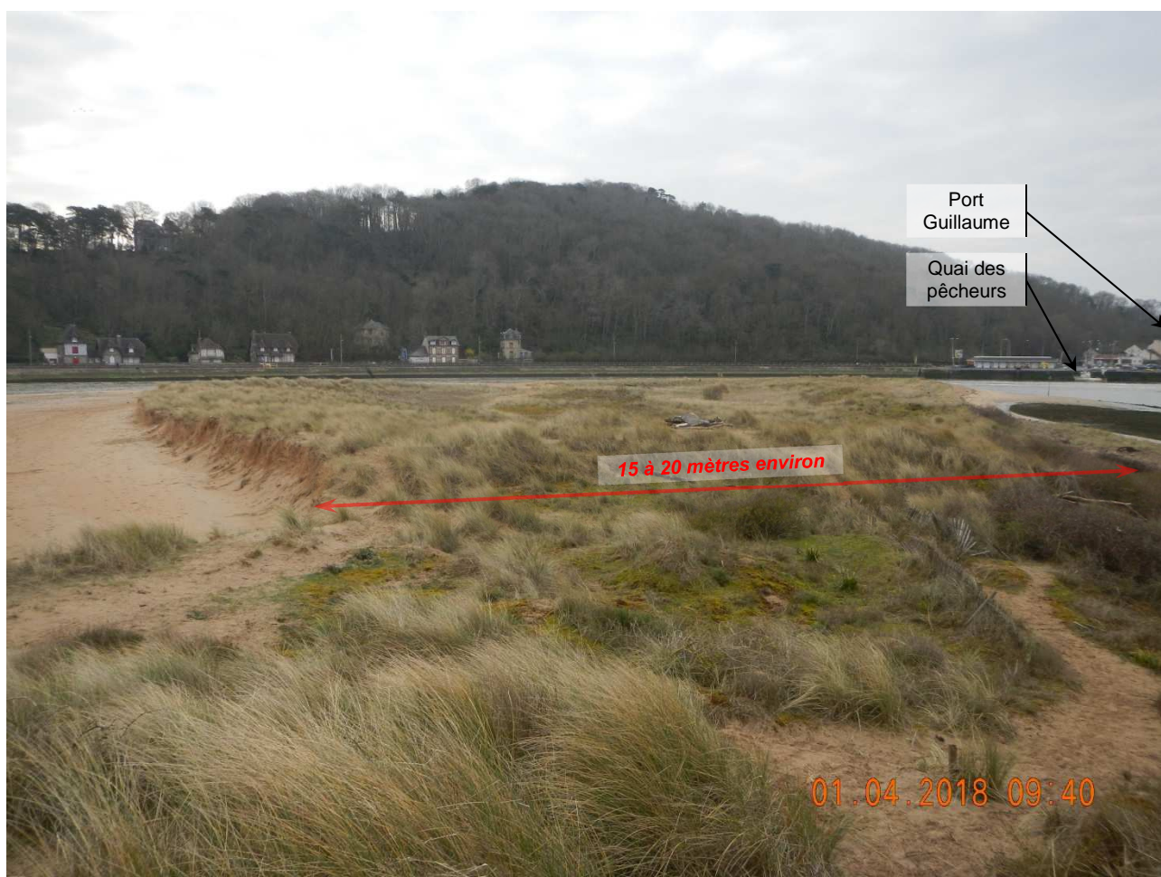
Photographie 15 : vue de l'extrémité de la flèche sableuse de Cabourg en direction du Sud-Est, illustrant l'étroitesse et la faible altimétrie à l'amorce du poulie - © LITTO Consult
