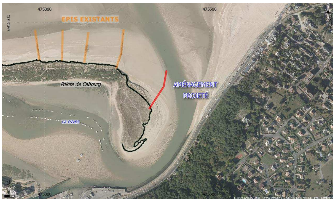
Photographie 3 : vue détaillée du tracé de l'ouvrage et position par rapport aux ouvrages de défense contre la mer existants (Orthophoto Littorale V2 août 2013 © MEDDE)
