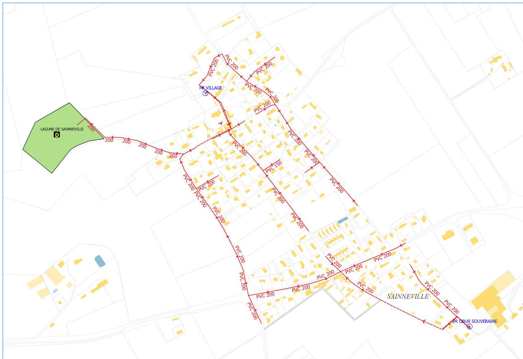
Figure 13 : Réseau assainissement collectif de Sainneville
