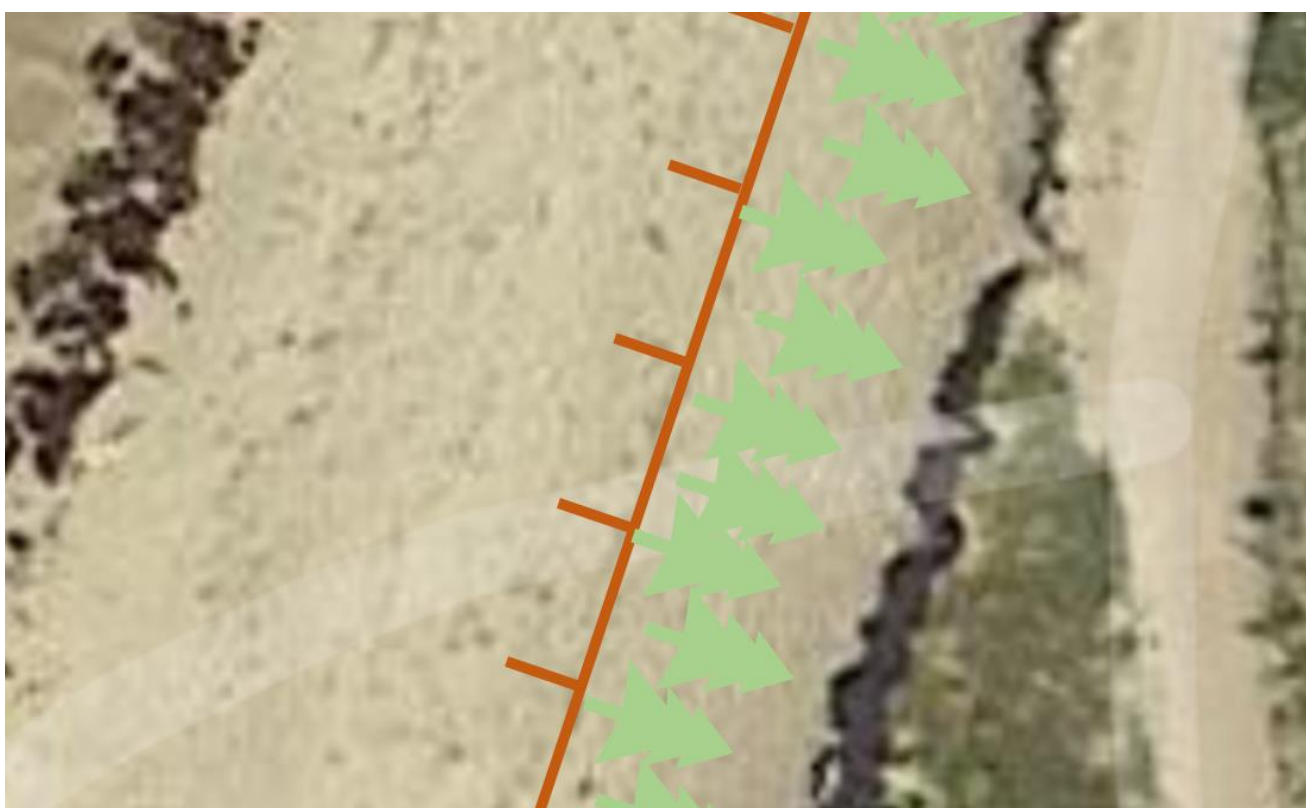
Figure 9 : Schéma d'implantation simplifié des fascines – Vue du dessus
