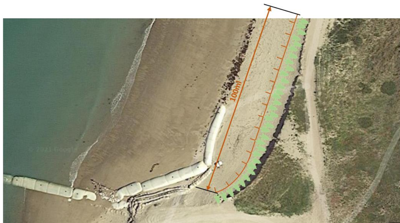
Figure 8 : Schéma d'implantation simplifié – vue de dessus des fascines
