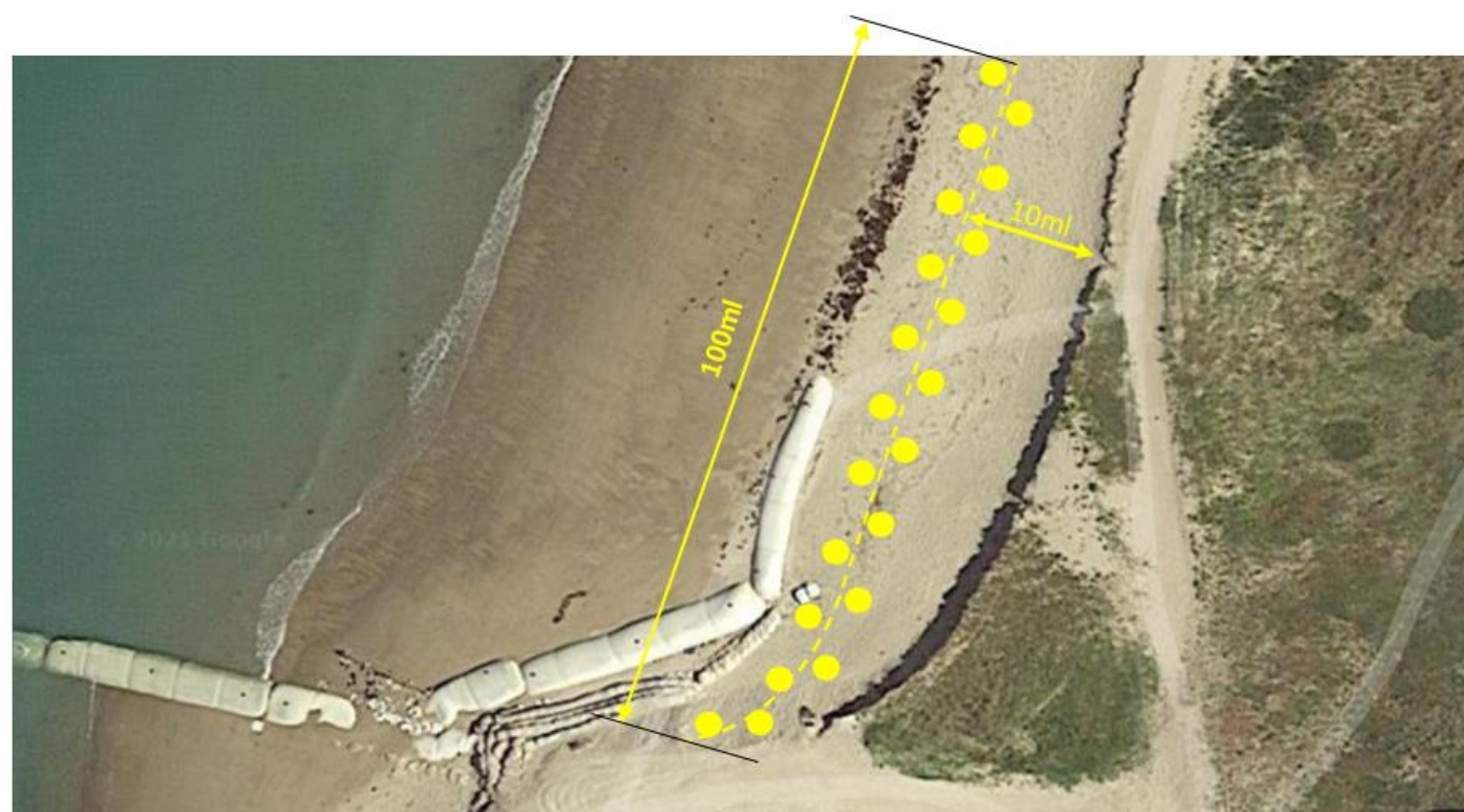
Figure 6 : Schéma d'implantation simplifié des pieux hydrauliques – vue de dessus des pieux
