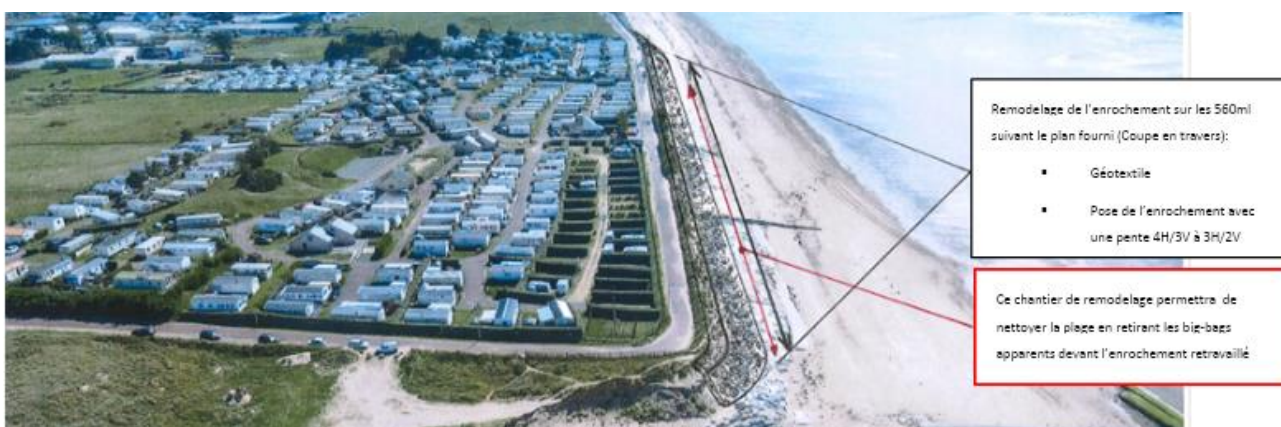
Figure 11 : Schéma d'implantation simplifié de l'enrochement
