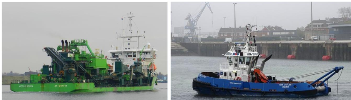
Figure 2-5. Drague Charlemagne Horta et remorqueur équipé d'une drague niveleuse (Source : SGRE, 10/2021).
