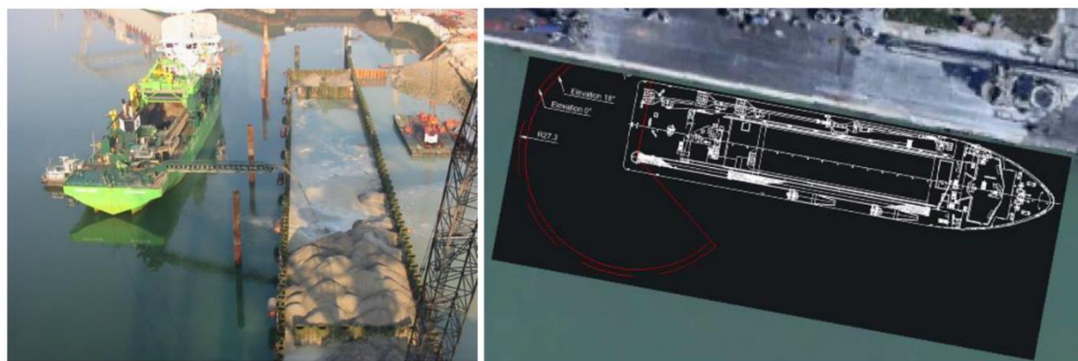
Figure 2-6. Exemple de déchargement de sédiments depuis d'une drague au-dessus du niveau de l'eau et plan du rayon de déploiement possible de la bande transporteuse (source : SGRE, 10/2021).
