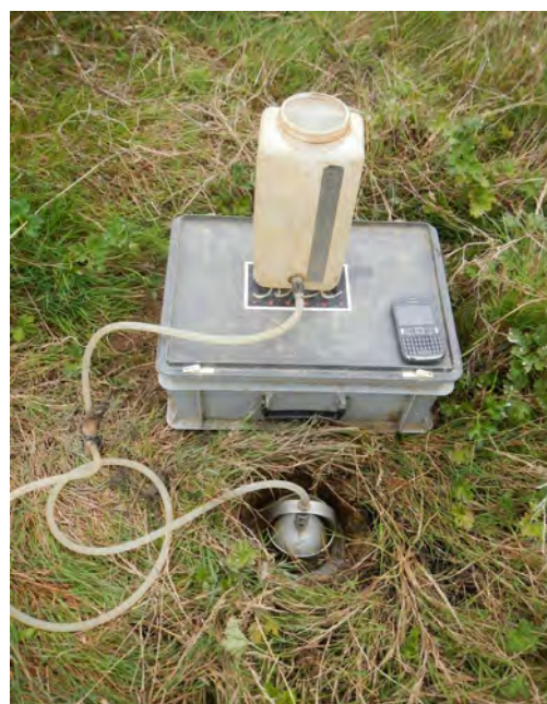
Figure 3 : Test de perméabilité
