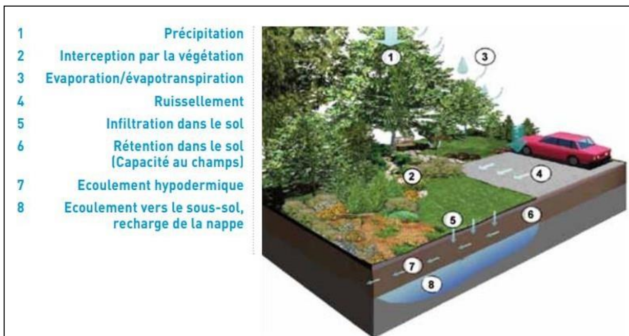
Figure 9 : Variables hydrologiques dans le concept d'aménagement paysager absorbant (source : AESN)
