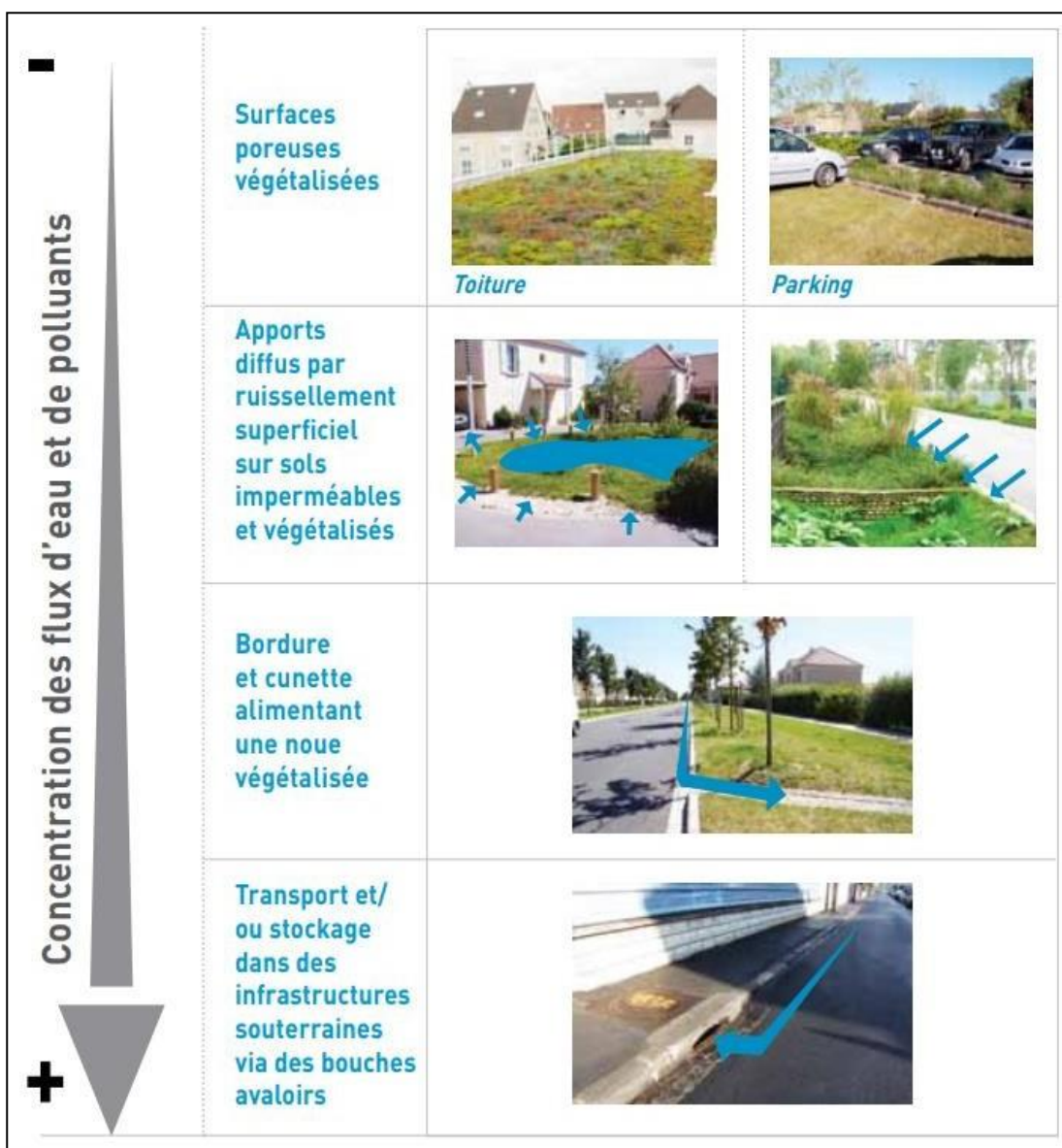
Figure 10 : Influence de la conception sur la concentration des flux d'eau et de polluants dans les ouvrages de gestion des es de gestion des eaux de ruissellement (source : AESN)
