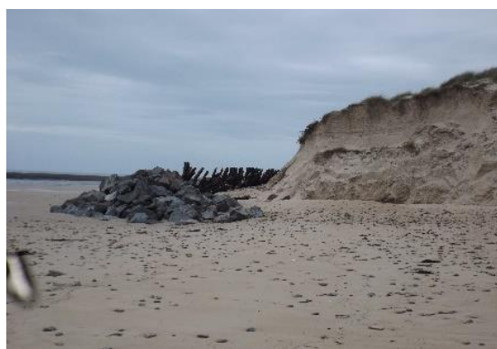
Figure 13. Illustration de la sape des sables de rechargements mis en place le 5 mars 2020, suite à la vive-eau d'équinoxe la semaine suivante (clichés COCM)
