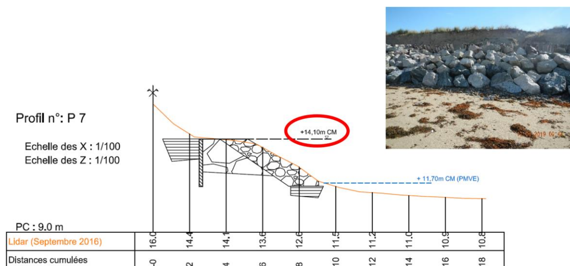
Figure 12. Coupe transversale type du tronçon terminal du perré de Saint-Germain-sur-Ay-plage, fortement dégradé (CASAGEC, 2020)
