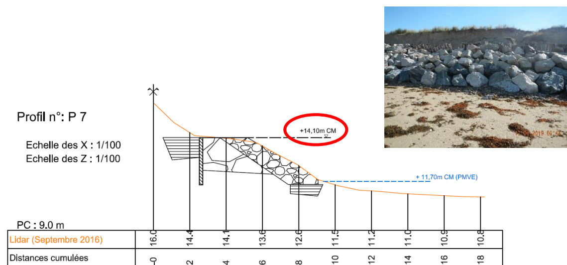
Figure 56. Coupe transversale type du tronçon terminal du perré de Saint-Germain-sur-Ay-plage, fortement dégradé
