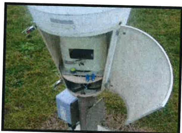
Pluviomètre à augets
