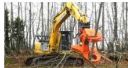
Ci-dessus : Coupe à blanc réalisée à l'aide d'une pince à grappin.
