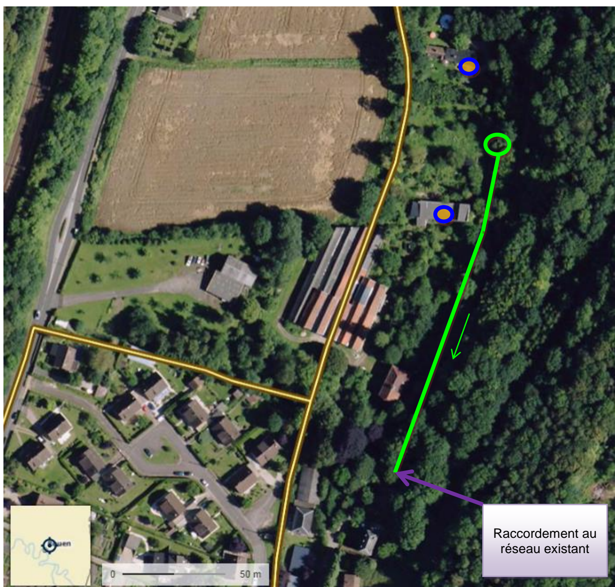
Figure 3 : Représentation graphique de la solution d'assainissement collectif étudiée pour le secteur du chemin du Vieux-Moulin (2 unités)
