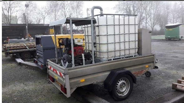
Remorque équipée d'une cuve à eau et d'un nettoyeur haute pression
