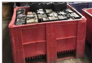
Batteries stockées en bacs étanches
