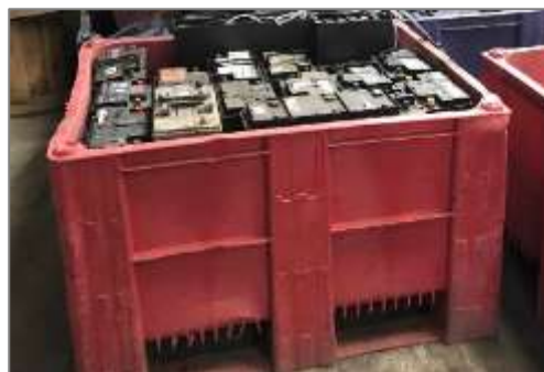
Stockage de transit des batteries en bacs étanches (sous le bâtiment d'exploitation)
