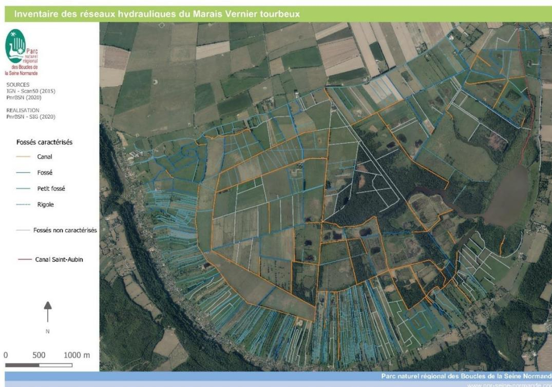
**Figure 63 : Réseau de drainage (non exhaustif) dans le marais ancien**
