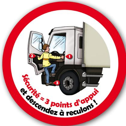
Autocollant relatif aux 3 points d'appui à respecter pour éviter les chutes lors de la montée ou de la descente d'un véhicule lourd (Ø=20 cm)
