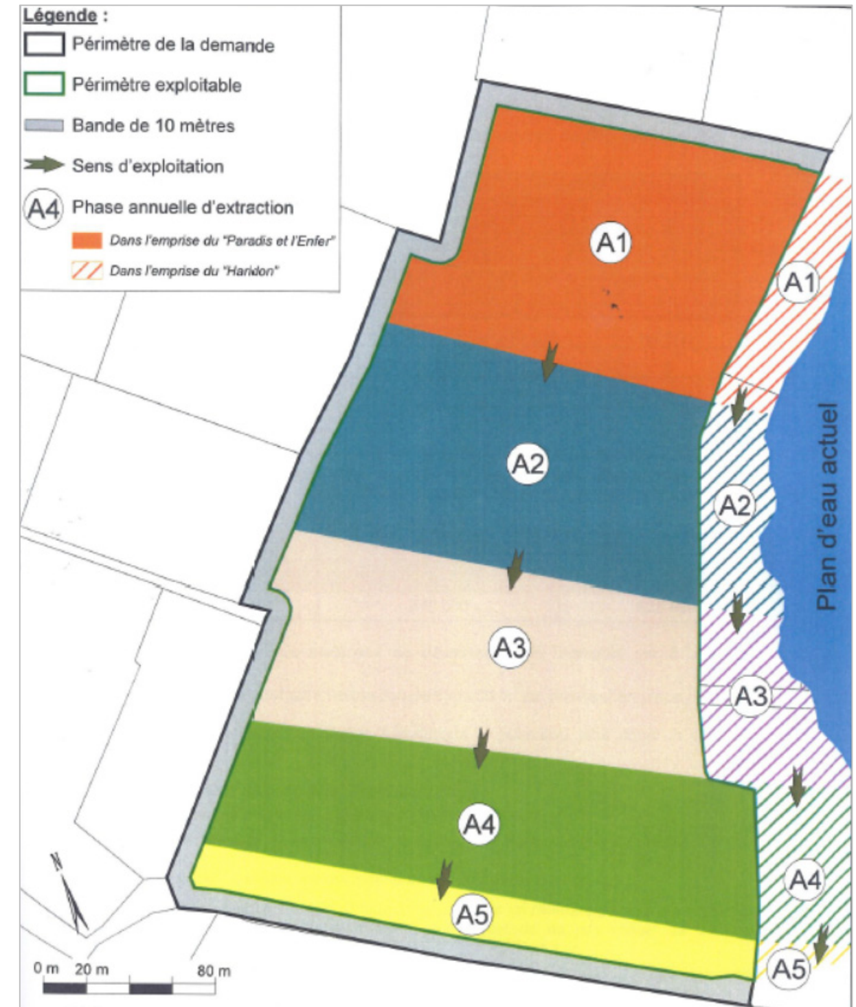
Figure 4 : Extrait du plan de phasage initialement autorisé pour « Le Paradis et l'Enfer » (source : dossier de demande GéoPlusEnvironnement)
