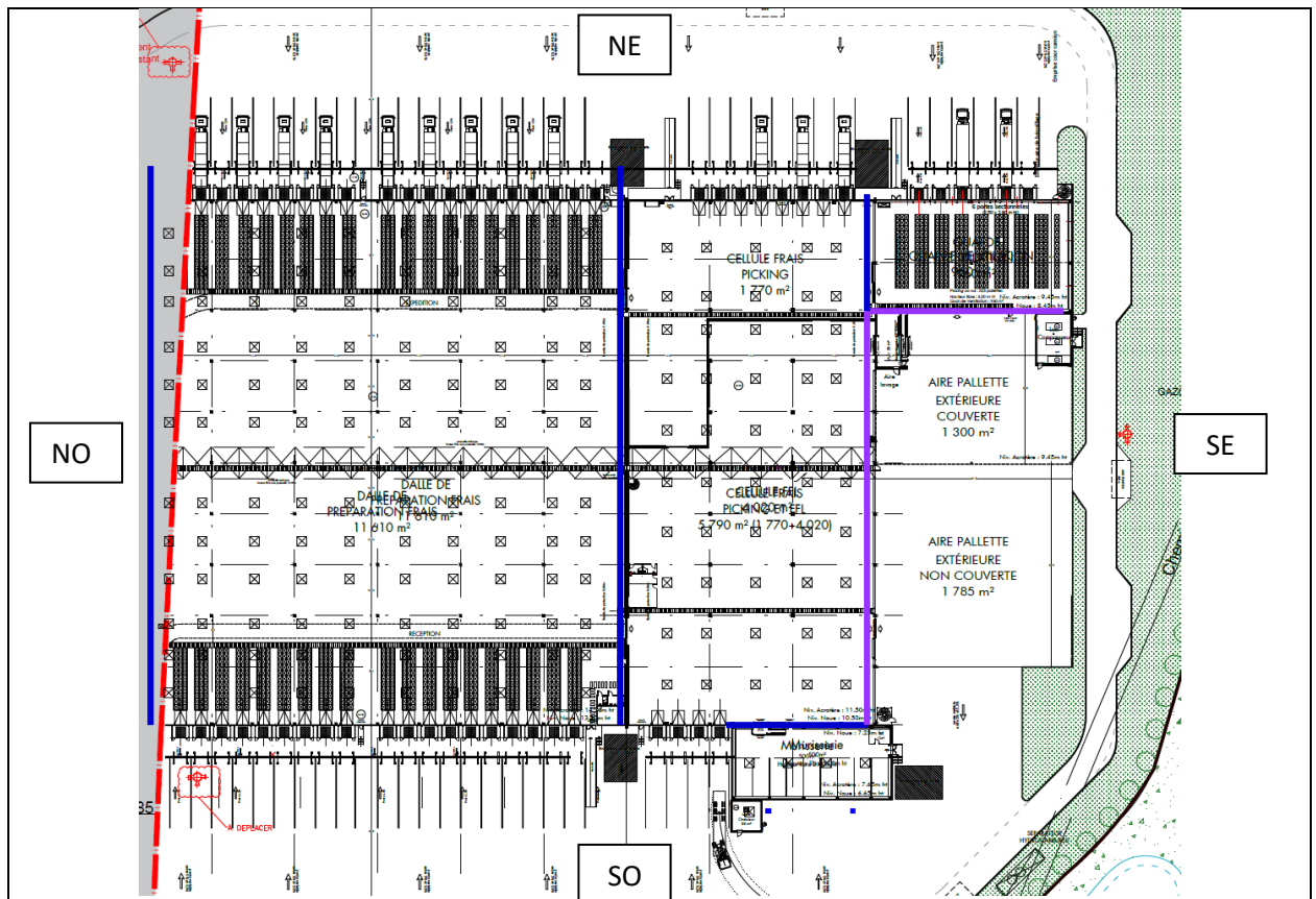
Figure 1 : Emplacement des murs coupe-feu.
