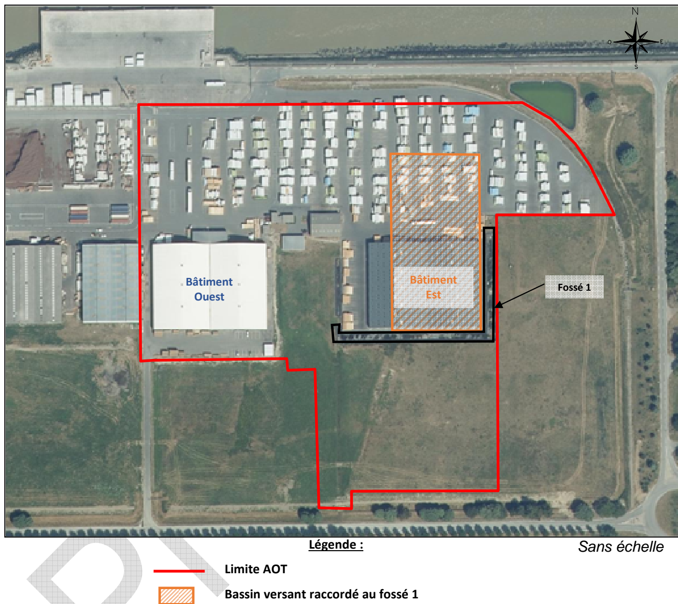
Figure 4 : Vue aérienne du site avec représentation du bassin versant relié au fossé 1
