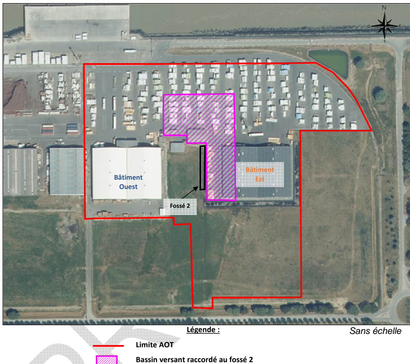
Figure 5 : Vue aérienne du site avec représentation du bassin versant relié au fossé 2
