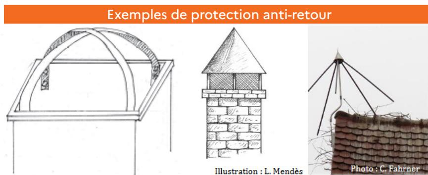
Dans tous les cas, le dispositif mis en place doit être conçu de telle façon qu'il ne retienne pas les branchages et les fasse glisser en contrebas. Il peut s'agir par exemple d'un chapeau de cheminée conique, de plaques métalliques lisses en forme de vé inversé, ou encore d'un « parapluie ».
