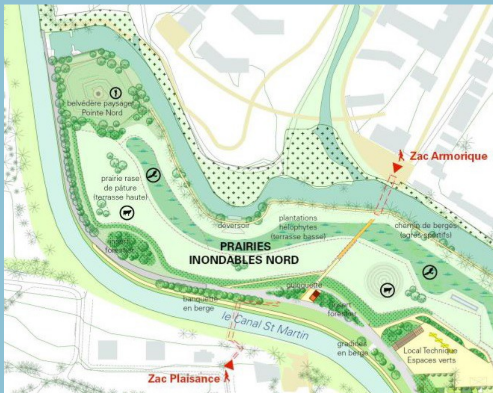
Illustration 34 : plan de situation de la zone d'expansion de crue située au nord des Prairies Saint-Martin (Rennes, 2015)
