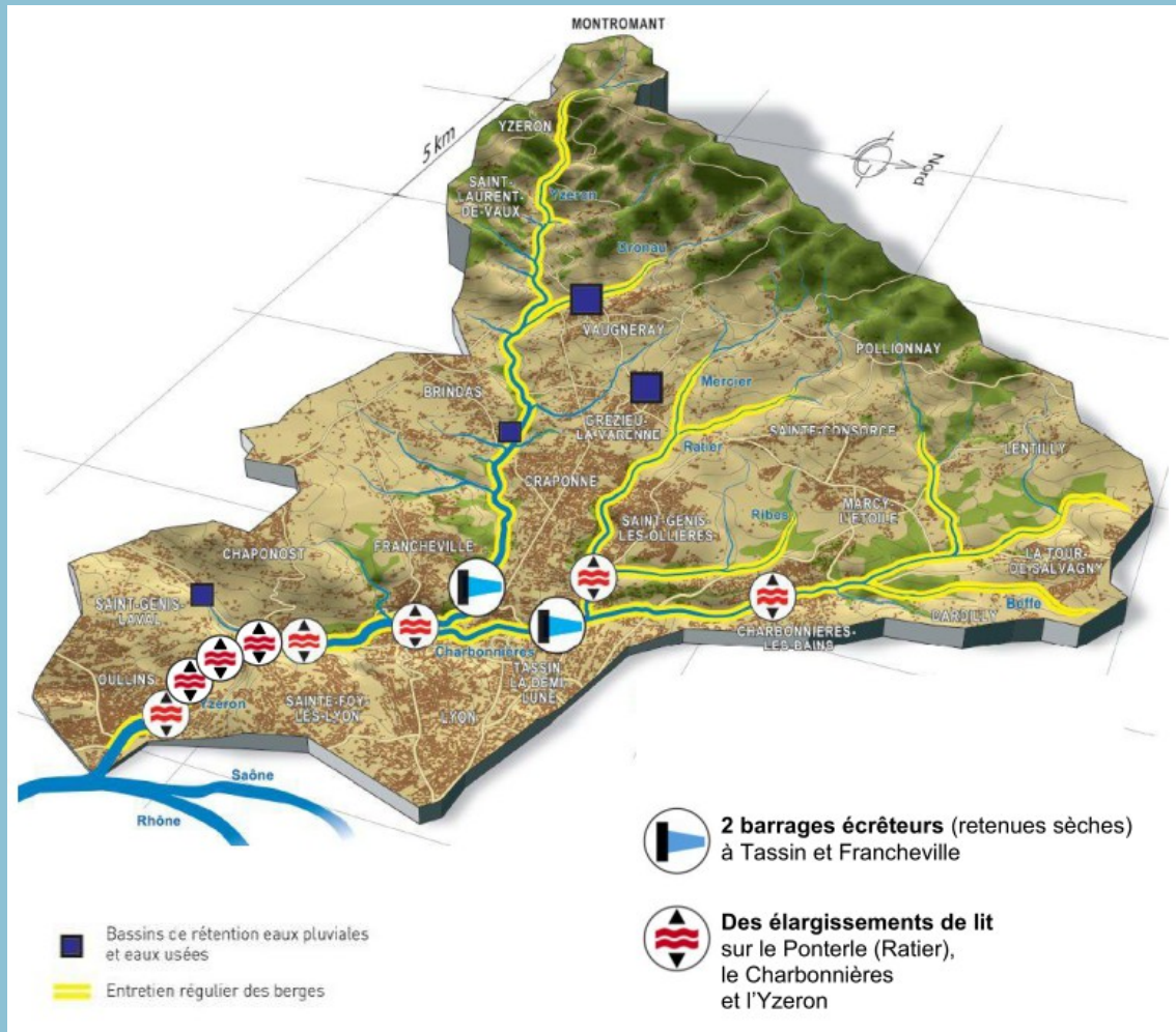
Illustration 31 : principe des travaux de protection contre les inondations et implantation des aménagements (SAGYRC, 2012)
