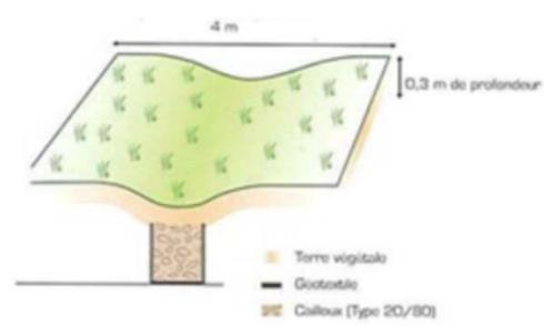
Eléments de dimensionnement des dispositifs de gestion des eaux pluviales
