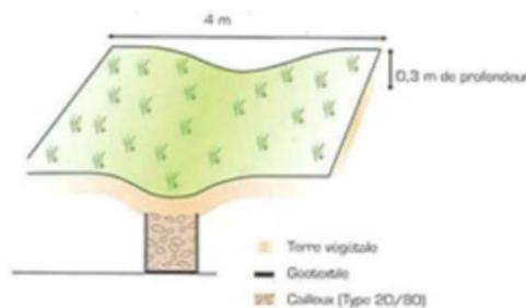
Eléments de dimensionnement des dispositifs de gestion des eaux pluviales
