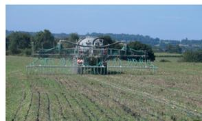
Utilisation d'un épandeur avec pendillard
