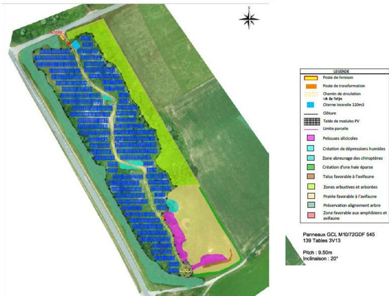
Figure 15 : Variante n°3 du plan d'implantation (source : Générale du Solaire)
