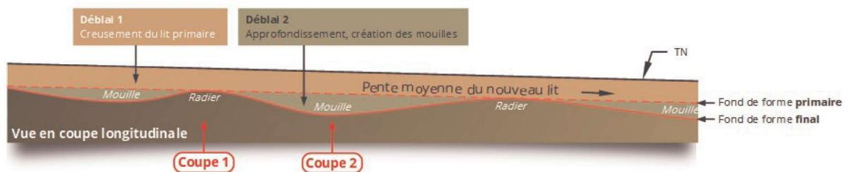
Figure 85 : Profil en long schématique – principe de diversification
