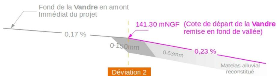
Figure 443 : Schéma de principe d'aménagement de la déviation 2
