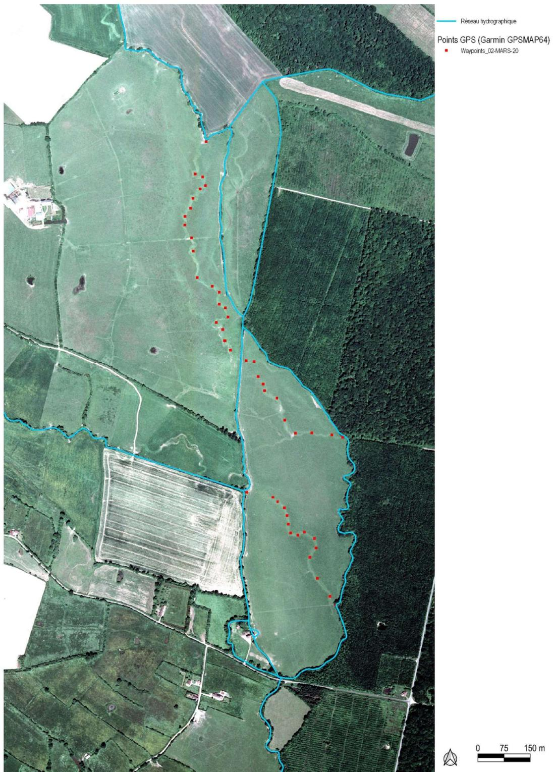
Figure 363 : Levés au GPS faits le 2 mars 2020 - Repérage des traces d'écoulements
