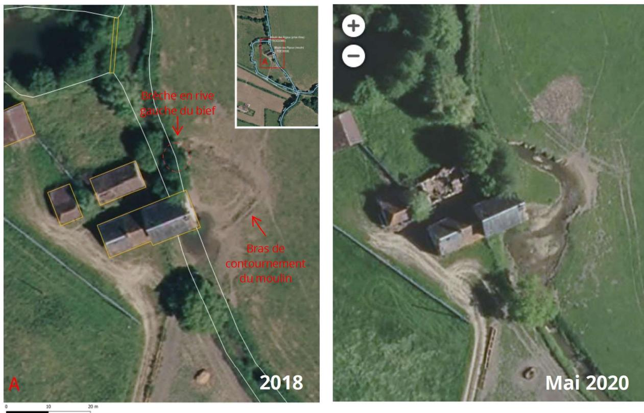
Figure 26 : Brèche au niveau du moulin des Rigoux
