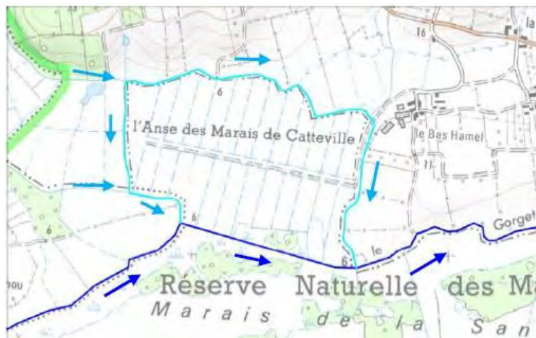
Figure 15 : Fonctionnement hydraulique actuel du shunt n°1
