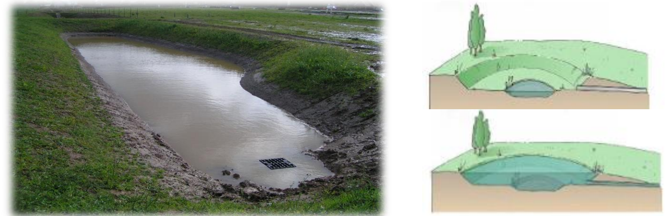
Schéma 34 : Mare fonctionnant par débit de fuite
