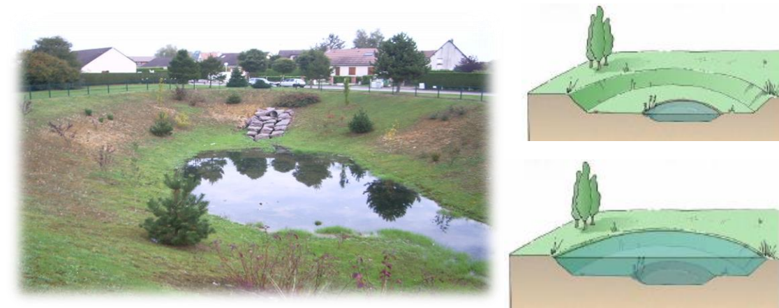
Schéma 33 : Mare fonctionnant par infiltration et trop plein
