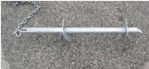
Composé d'un tube en acier galvanisé biseauté à l'extrémité basse et muni d'un anneau à l'extrémité haute. Le tube reçoit de 1 à 2 disques de grand diamètre qui assurent une excellente tenue. Ces disques sont vrillés et chanfreinés pour faciliter l'enfouissement. L'ancrage à vis limite l'emprise au sol par rapport à un corps-mort classique et donc, évite de trop endommager les fonds marins. La résistance mécanique du sol conditionne l'ancrage et son dimensionnement.
