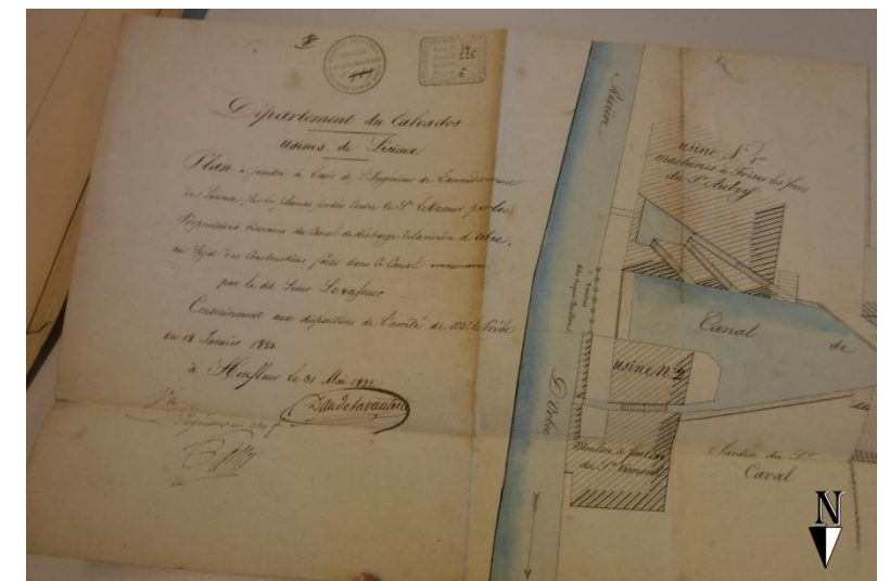
Plan de l'ouvrage du Carmel. En rive gauche trois roues, en rive droite une roue. Au nord le bras usinier, au sud le bras de décharge (1822). (Source : Archives départementales 14).
