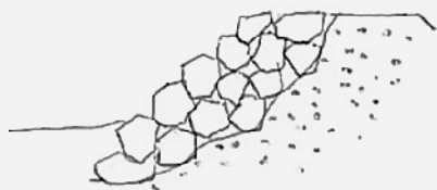
Mise en place aléatoire
