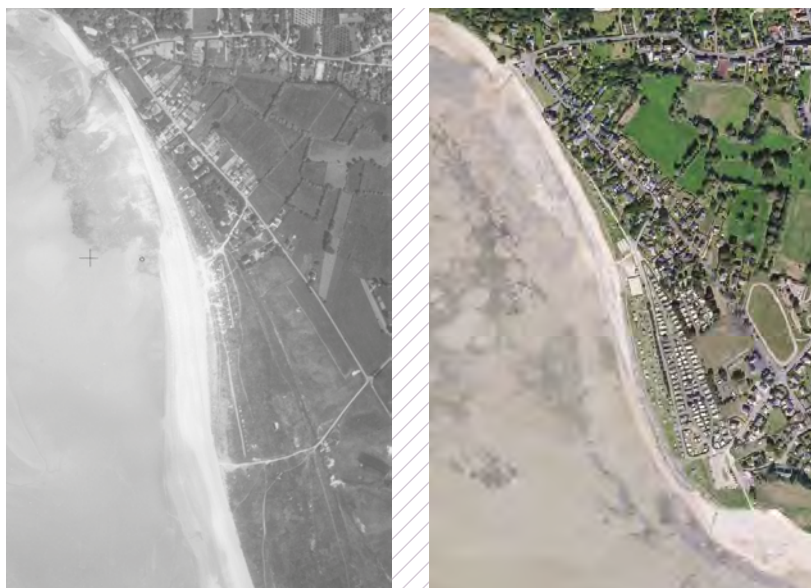
Photos aériennes remises à la même échelle. A gauche, situation 1952, rivage mobile. A droite, situation 2002, avec une érosion très marquée au sud de l'enrochement. ©IGN-Paris 2017 - reproduction interdite.
