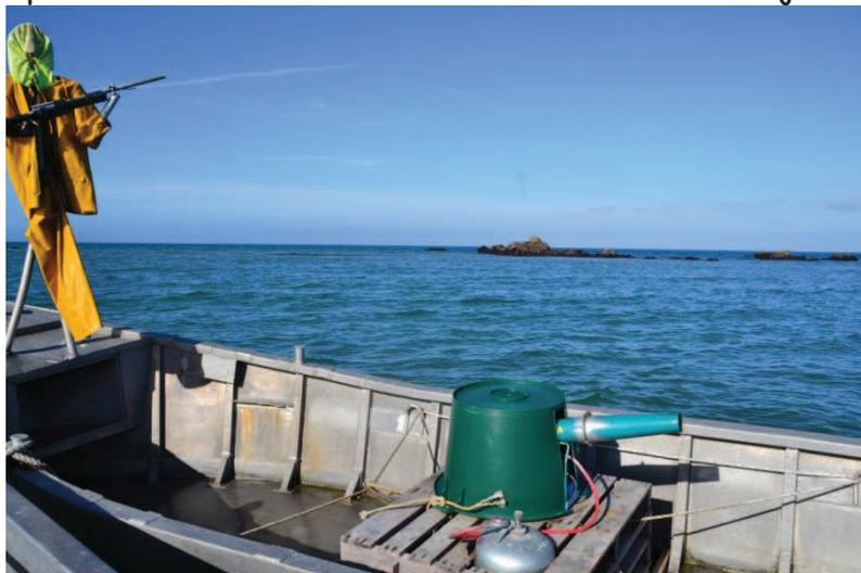
Présence également d'un canon à gaz qui est inséré dans une bassine en plastique et alimenté par une bouteille de gaz.
