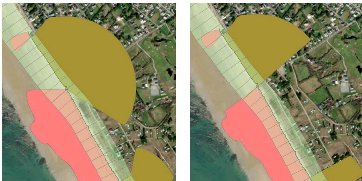
Figure 62 : Découpage des zones de projection au droit des casiers pour supprimer les superpositions de secteurs en accrétion avec des secteurs en érosion.
