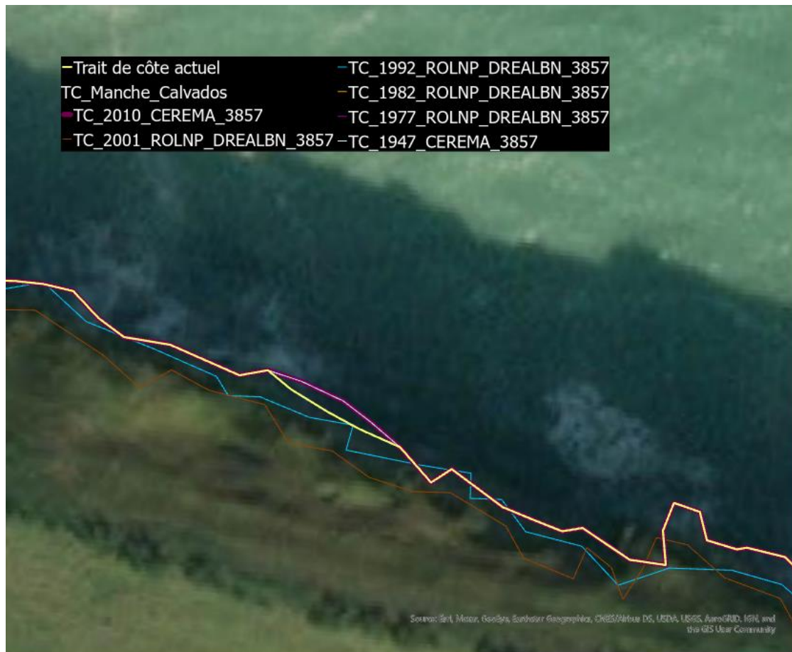
Figure 3 Exemple d'erreurs de digitalisation des traits de côte au niveau des falaises du Calvados
