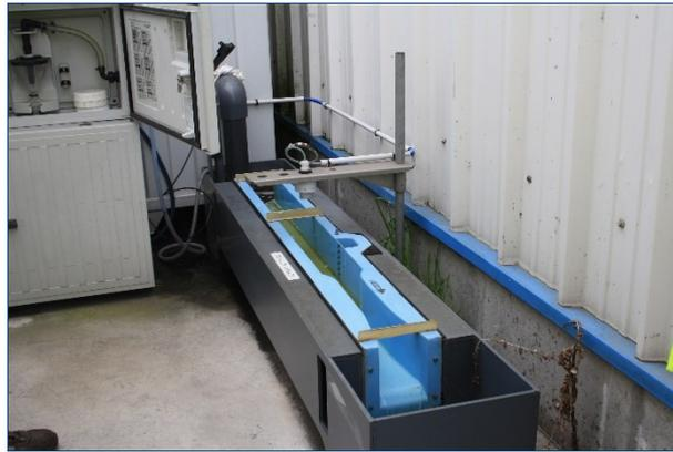
Photo 11 : Canal de mesure en sortie de STEP
