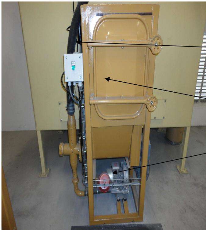
**Tuyau d'injection réactif**
