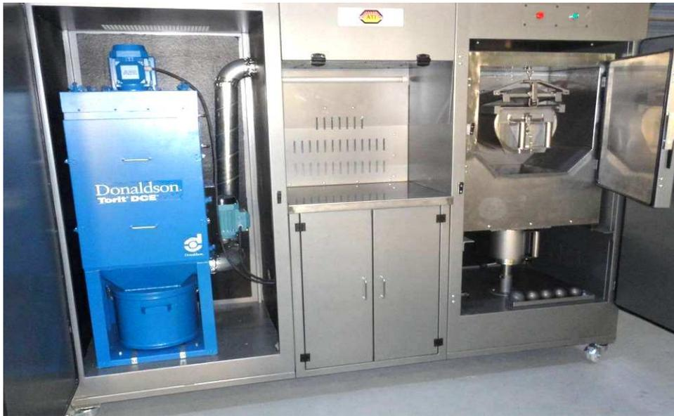
► L'équipement se compose d'un pulvérisateur de calcius à boules couplé à un système d'aspiration.
