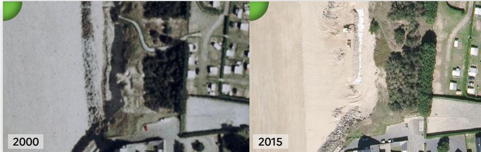
Destruction des enrochements par la mer, recul du trait de côte et réalisation de nouveaux enrochements « en arrière » Hauteville-sur-Mer (remonterletemps.ign.fr).
