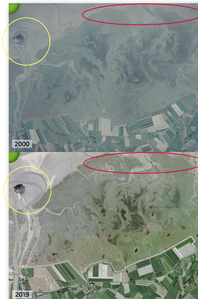
Le Mont Saint-Michel, entre 2000 et 2019 : Les herbus ont progressé vers l'intérieur de la baie (cercle rouge). Le pourtour du Mont s'est désenvasé (cercle jaune), le tracé du GR 223 le long des polders a été aménagé (remonterletemps.ign.fr).
