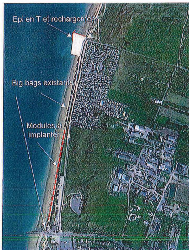
Figure 2 : Schéma de principe du dispositif global de protection prévu à court terme (le rechargement ne fait pas partie du présent appel d'offre)
