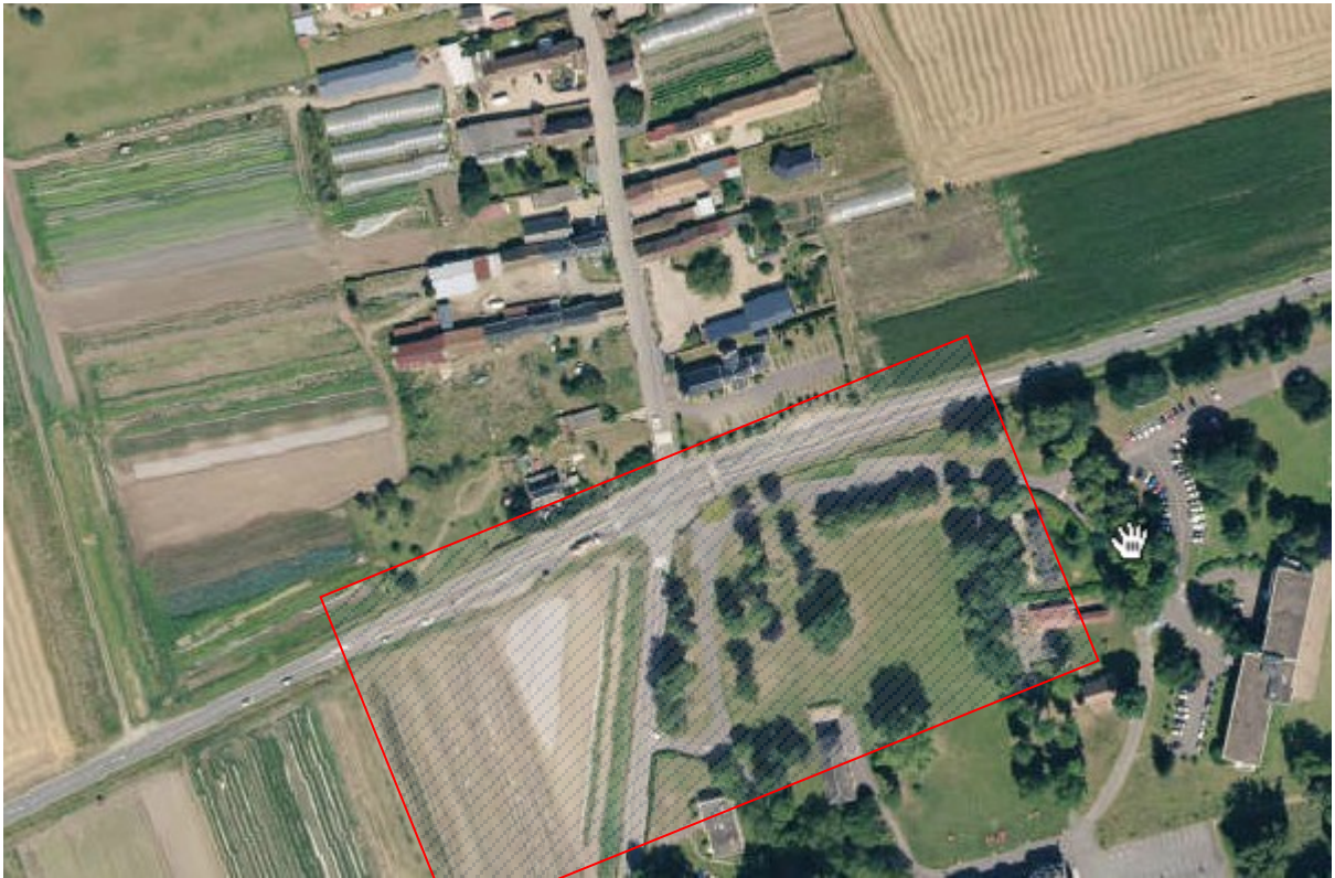
Optimisation du fonctionnement du carrefour à feux de Martot avec prolongement des voies de stockages.
