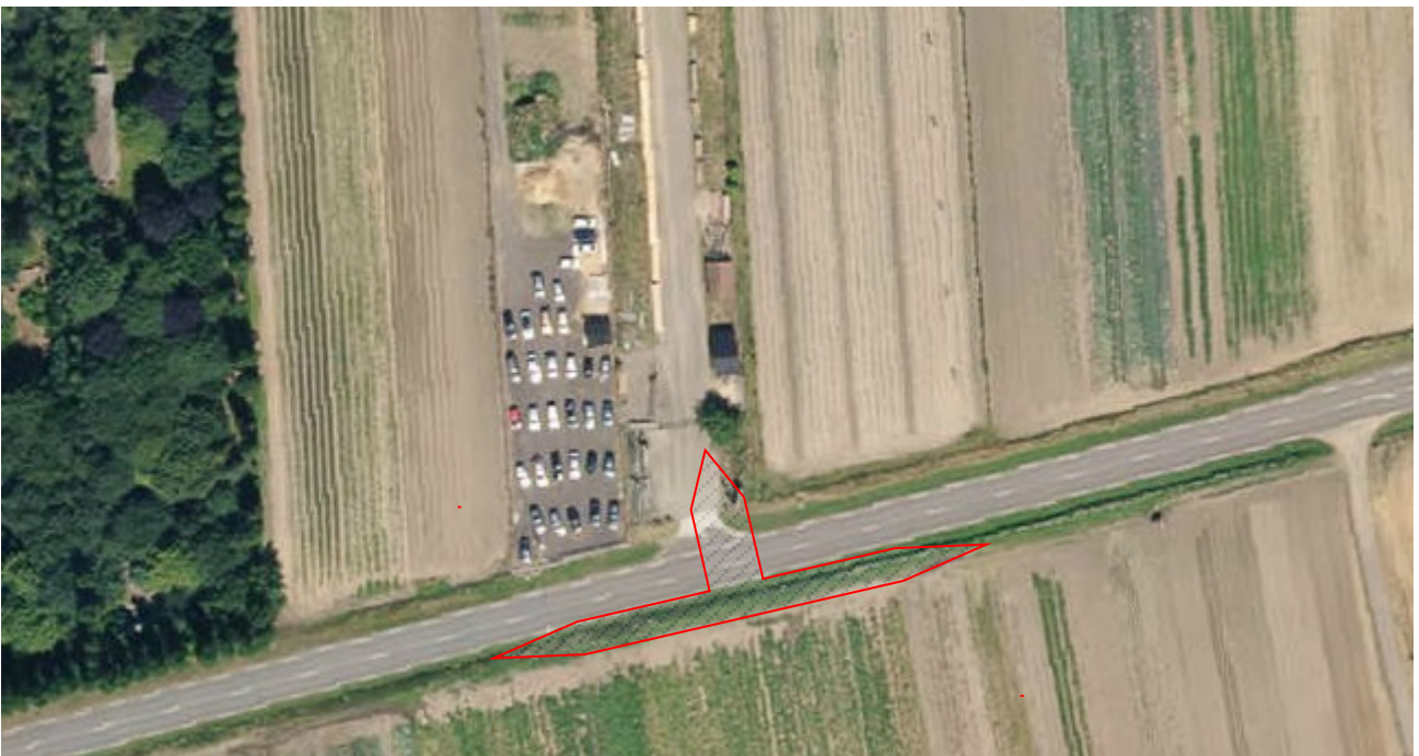
Aménagement du carrefour n'autorisant que les mouvements de tourne-à-droite
