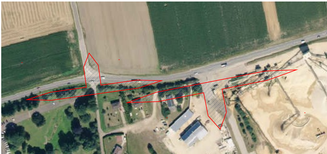
Aménagement d'un "double" tourne-à-gauche et rectification du double virage en "S"
