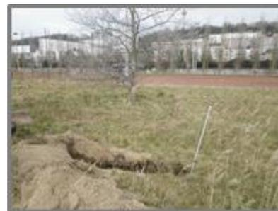
Deux autres points de sondages ont été réalisés à l'aide d'une mini pelle sur 1,80 m de profondeur environ. Les implantations de sondage sont présentées en Annexe 1.
