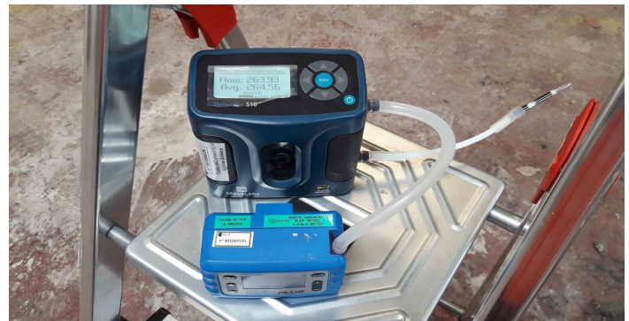
Vue détaillée de la ligne d'échantillonnage avec contrôle débit
