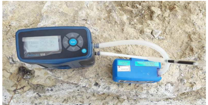
Vue détaillée de la ligne d'échantillonnage avec contrôle débit
