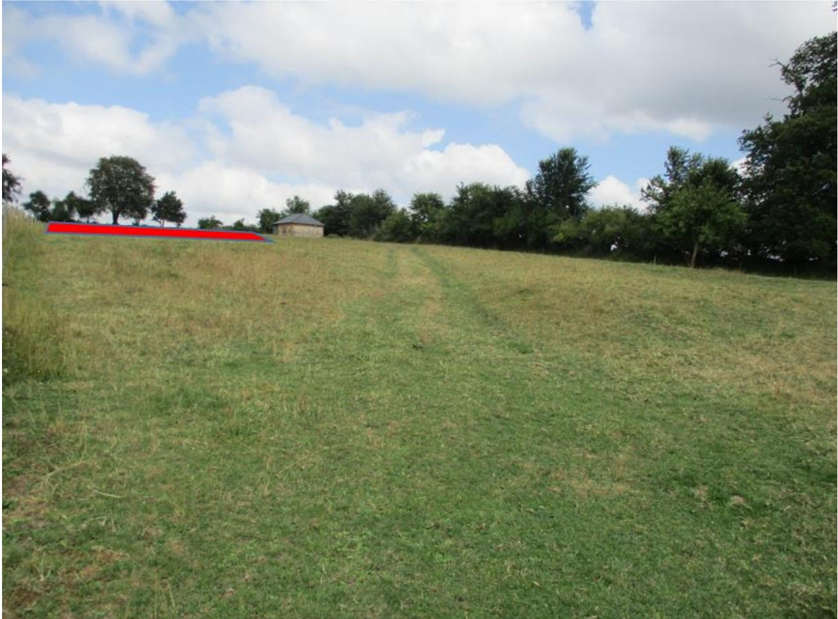
*Illustration 4 : photo de la zone d'implantation (en rouge) du piézomètre au sein de la parcelle – la localisation exacte au sein de cette zone sera définie avec le propriétaire au démarrage du chantier*
