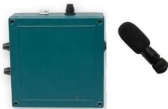
Figure 16 : Détecteur et enregistreur d'ultrasons SM2BAT + Wildlife
