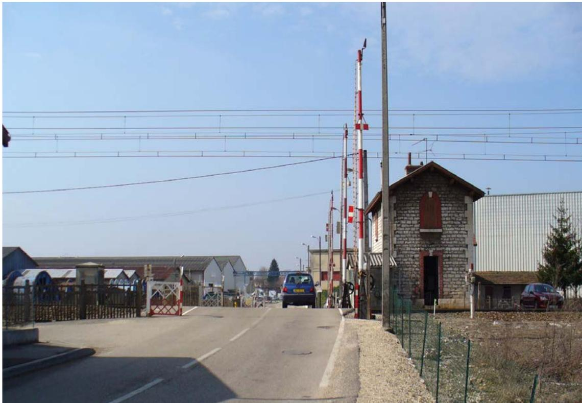
Il existe encore des passages à niveau gardés, lorsque la traversée dépasse 24 mètres ou si la vitesse des trains est  $>$  à 200km/h. Le plus souvent, ils sont équipés de barrières ou demi-barrières, manœuvrées par des agents SNCF.
