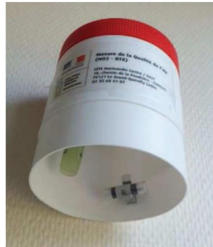
Dispositif de mesure avec un tube BTX et un tube NO<sub>2</sub> (CEREMA DTer NC)
