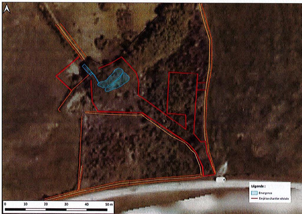
*Le débroussaillage au niveau de la résurgence sera réalisé sur une surface de l'ordre de 90 m<sup>2</sup> de manière à pouvoir faire des prélèvements permettant de délimiter avec précision la zone à excaver.*
