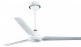
Ils permettront de valoriser au mieux les dégagements calorifiques de l'éclairage et des occupants en période de chauffage et réduiront les temps de fonctionnement des ventilateurs des roof-tops (les ventilateurs des roof-tops consommant 0,30 W/m<sup>3</sup>/h contre 0,02 W/m<sup>3</sup>/h traité pour les déstratificateurs)
