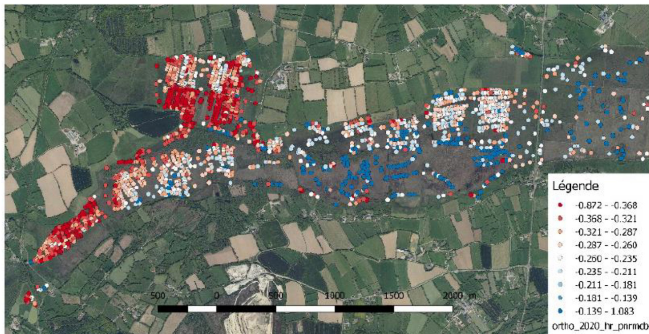
Figure 21 - Évolution topographique de l'altitude de la tourbière de la Sangsurière et de l'Adriennerie entre 1998 et 2023 (Bouillon, 2024). Sur cet exemple les points rouges marquent l'abaissement topographique résultant de phénomènes multiples dont la minéralisation de surface.
