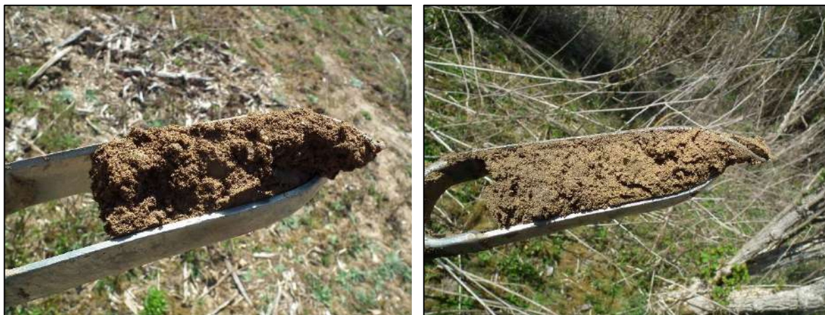
Figure 54 : Sondage 2 à gauche (sol remanié ?) et Sondage 7 à droite (limono-sableux)
